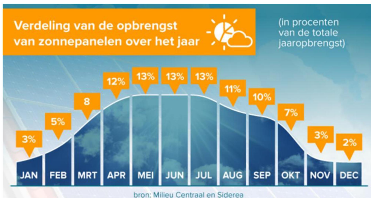
Figuur 3. Verdeling opbrengst van zonnepanelen over het jaar
